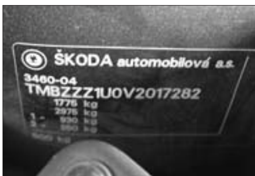
Na detailním snímku typového štítku můžete rozeznat název výrobce, VIN kód karoserie, maximální přípustnou hmotnost naloženého vozidla, naložené soupravy a přípustné zatížení přední i zadní nápravy
