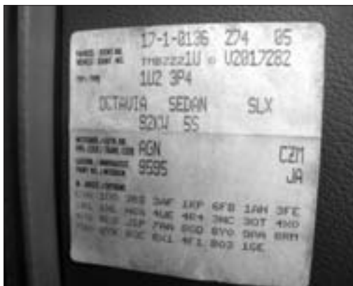
Datový štítek najdete po otevření dveří řidiče na víčku pojistkové skříňky. Shodný datový štítek se nalézá v servisní knížce.
