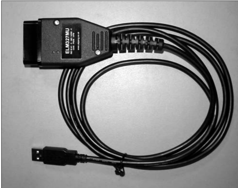
Propojovací kabel mezi zásuvkou a počítačem pro OBD II. Lze jej použít jak pro diagnostický software, tak i k úpravě dat v paměti ECU.
