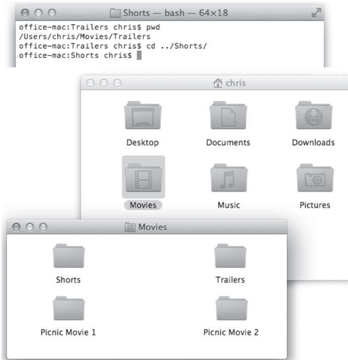
Obrázek 16.4: Dvojtečka říká Unixu, aby zaměřil svůj pohled na adresář Movies (tedy přejít výše v adresářové struktuře); zbytek mu říká, aby poté přešel do adresáře Shorts. Všimněte si, že kurzor vždy prozrazuje aktuální adresář.
